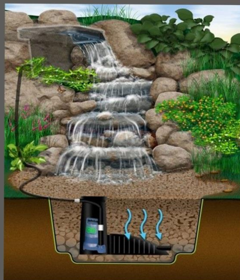
Rys. 2 kaskada z podziemnym zbiornikiem
